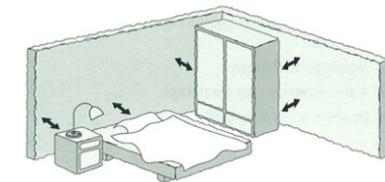
Besonders gern macht sich Schimmelpilz in Ecken breit, in denen zwei Außenwände aufeinander treffen. Sorgen Sie dafür, dass auch diese Zonen gut durchlüftet werden. Dichte Gardinen und Vorhänge können beispielsweise eine unüberwindbare Barriere für Frischluft sein.
